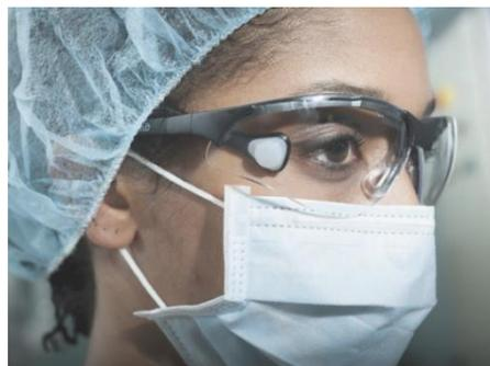
Grace au serre-tête, le dosimètre s'ajuste à la bonne dimension ce qui permet de s'assurer que le dosimètre reste bien placé. Le diamètre minimal requis pour que le bandeau soit suffisamment serré est de 12 cm
