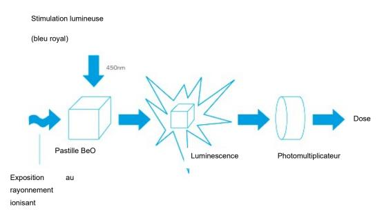
En raison de l'équivalence tissu du BeO, la courbe de réponse en énergie est pratiquement plate. Cela signifie qu'il ne faut pas de filtres de correction.
