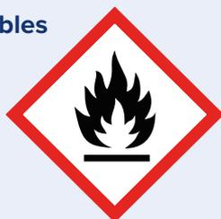
**Les gaz inflammables** tels que l'hydrogène, le butane et le propane sont toujours gazeux et inflammables dans les conditions atmosphériques. **Les liquides inflammables** sont toujours liquides dans les conditions atmosphériques. Leur point d'éclair et leur tension vapeur déterminent s'ils sont explosifs dans les conditions atmosphériques.
