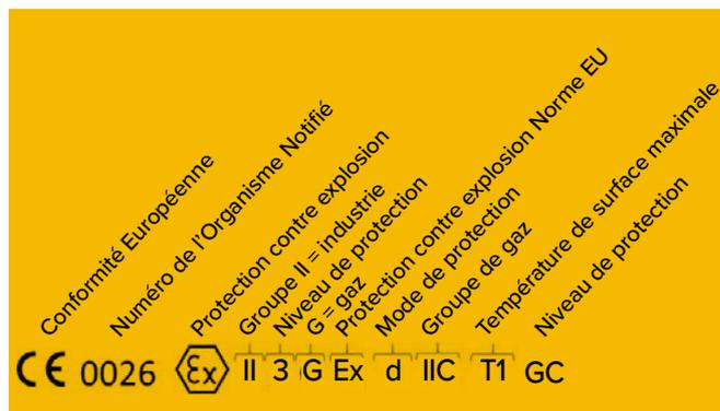
Dans une zone ATEX, il est obligatoire d'utiliser du matériel certifié ATEX. Les appareils antidéflagrants sont marqués d'un marquage ATEX. Ce marquage se compose de deux parties :
